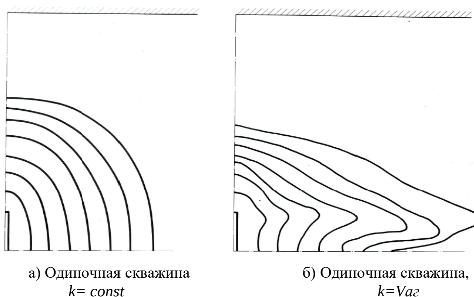
Рисунок 1 – Результаты моделирования процесса нагнетания через одиночную скважину
