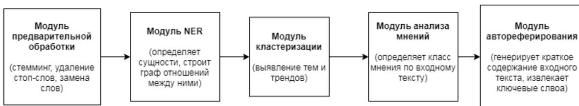
Рисунок 4– Последовательность NLP-обработки в IDOL
