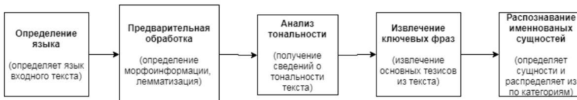
Рисунок 3 – Последовательность NLP-обработки в Microsoft Azure Cognitive Service
