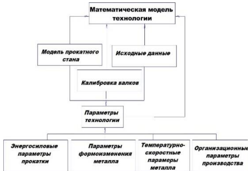
Рисунок 1 – Структурная схема математической модели сортовой прокатки
