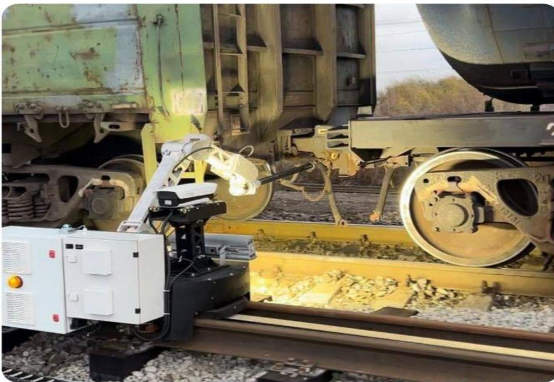
Рисунок 2 – Расцеп вагонов с помощью манипулятора РТК на сортировочной горке станции Челябинск-Главный
