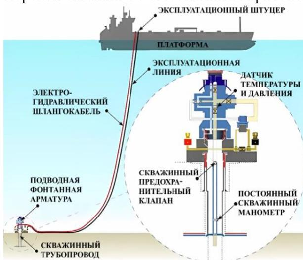
Рисунок 1 – Система подводной добычи нефти и газа: источник: [20, с. 3]
