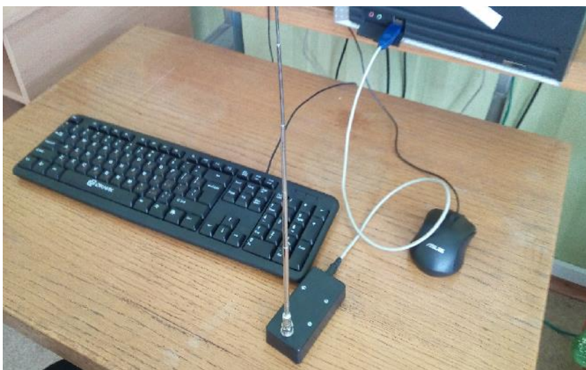
Рисунок 2 – Внешний вид сканирующего приемника, подключенного к ПК
