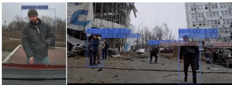
Рисунок 9 – Выполнение трекинга посредством YOLO v3
