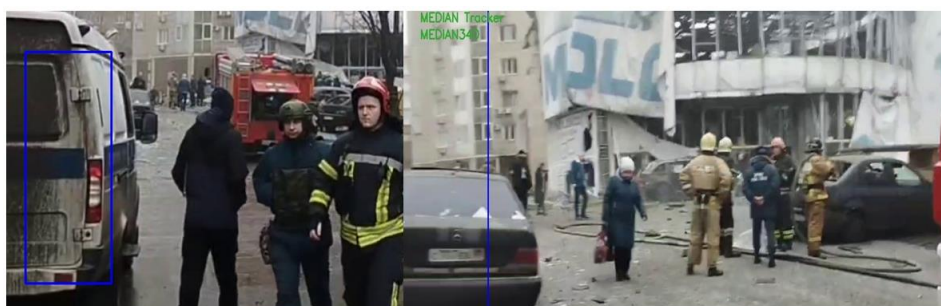
Рисунок 7 – Выполнение трекинга алгоритмом Median Tracker
