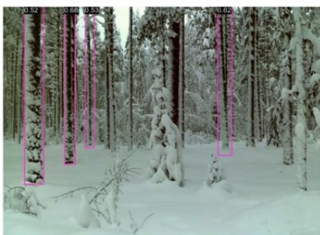
Рисунок 3 – Детектирование стволов деревьев зимой.
